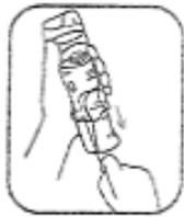
Afferrando saldamente l'anello nero della parte inferiore, tirare per estrarre la parte inferiore dalla camera d'aria (dal distanziatore).
